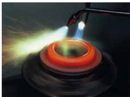
Мал. 12 Використання етину для нанесення захисного покриття на металевий виріб
