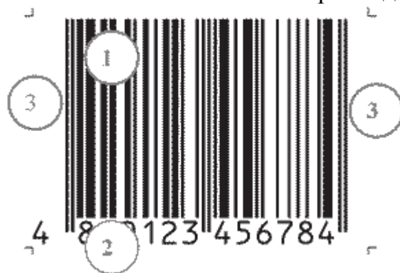
Рисунок 3.3 – Основні обов'язкові елементи штрихкової позначки EAN-13: 1 – рядок інформаційних та службових знаків штрихового коду; 2 – рядок візуальнозчитних знаків, що відображує подані в штриховому коді дані у формі, придатній для розуміння людиною; 3 – ліва та права вільні зони (зони стабілізації) - обов'язкові елементи штрихкової позначки
