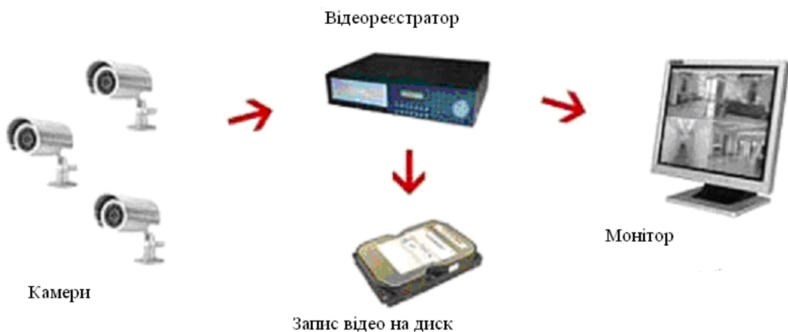
Рисунок 5.6 – Склад цифрової системи відеоспостереження на базі відеореєстратора
