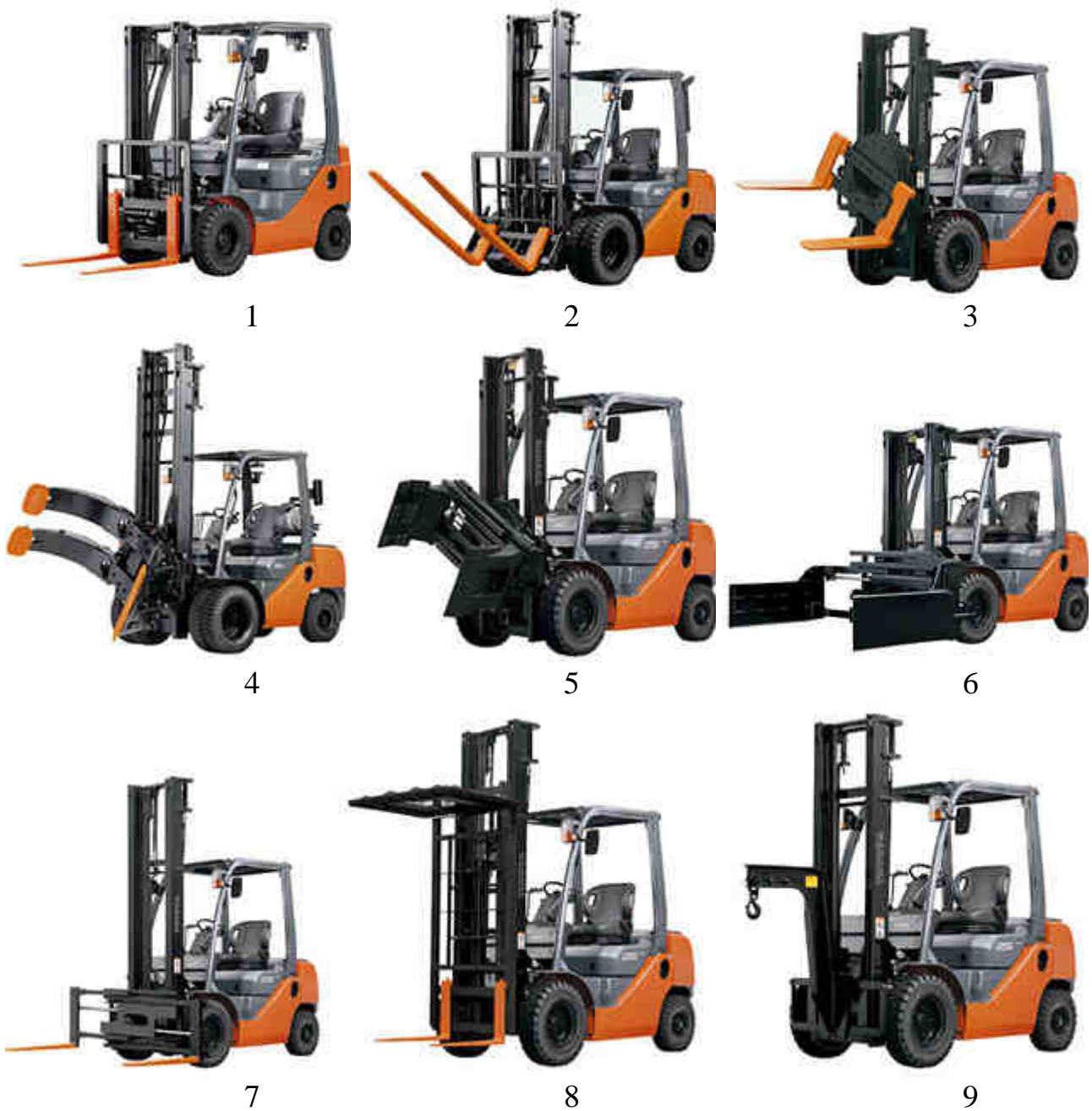
Рисунок 6.9 – Вигляд навантажувачів з вантажозахватними пристроями: 1 – каретка бічного зсуву; 2 – вила, що нахиляються по вертикалі; 3 – повноповоротний вилочний захват; 4 – повноповоротний захват рулонного паперу; 5 – захват бічний для бочок; 6 – захват бічний для тюків; 7 – вилочний захват палет, який позиціонується; 8 – захват з верхнім притиском; 9 – кранова стріла
