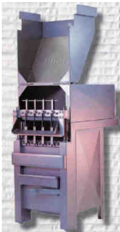
Рисунок 6.35 – Машина GFR 450 (гільйотина): а – загальний вигляд; б – вигляд нарізаного продукту
