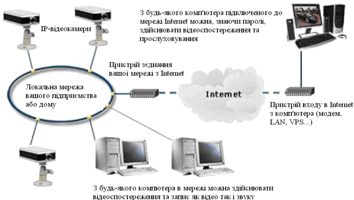
Рисунок 5.8 – Склад IP системи відеоспостереження
