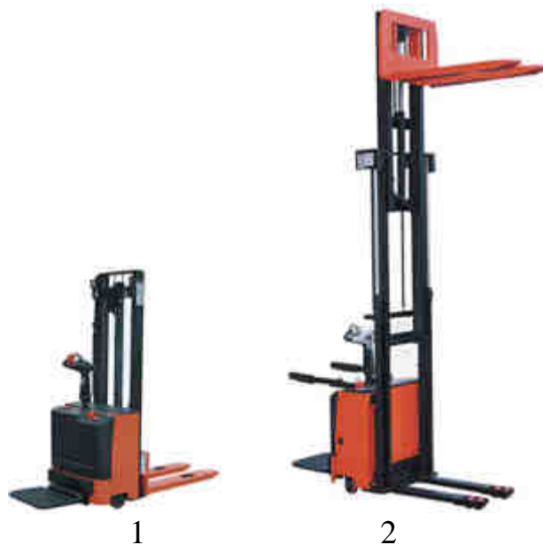
Рисунок 6.5 – Штабелери електричні самохідні для переміщення палет: 1 – CL1032; 2 – CL1534A
