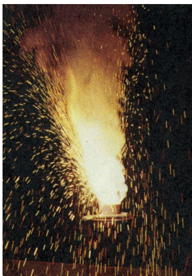
Мал. 67. Відновлення заліза із ферум оксиду алюмінієм. Цей процес називають алюмотермією
