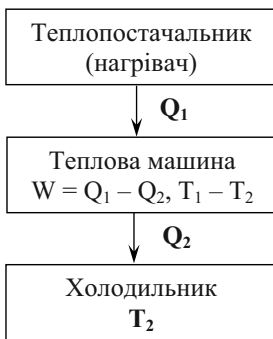
Рис. 2. Схема переходу теплоти в роботу у теплому двигуні
