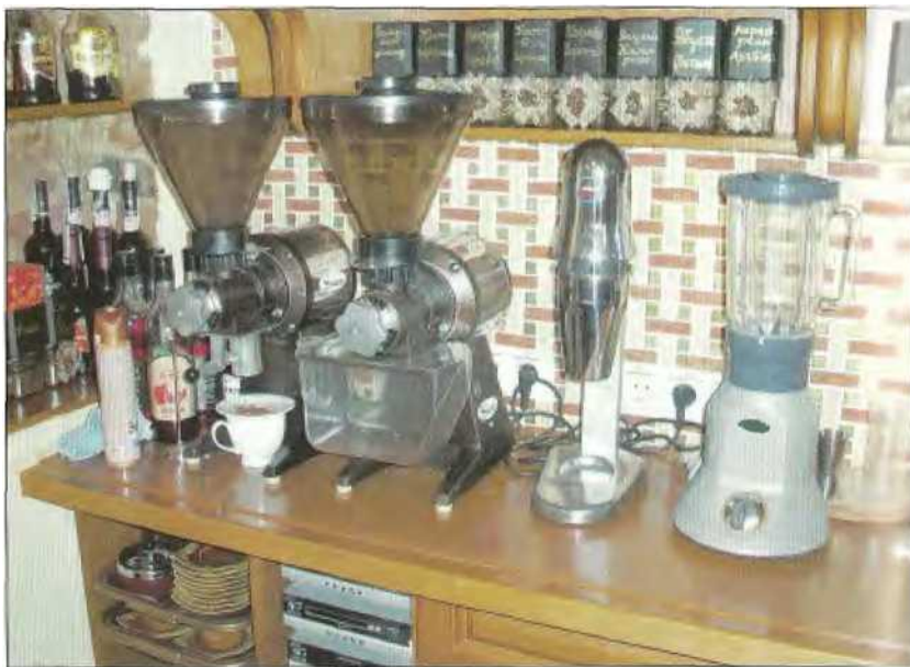
Механічне обладнання бару. Зліва направо: каворозмелювачі, міксер, блендер
