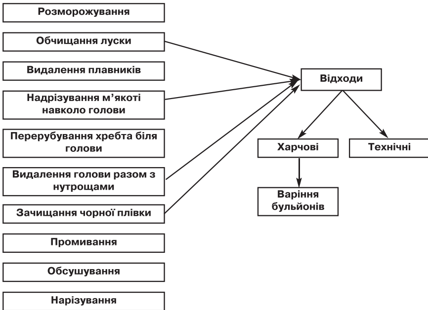
Рис. 19. Технологічна схема розбирання риби на порційні шматочки — кругляки
