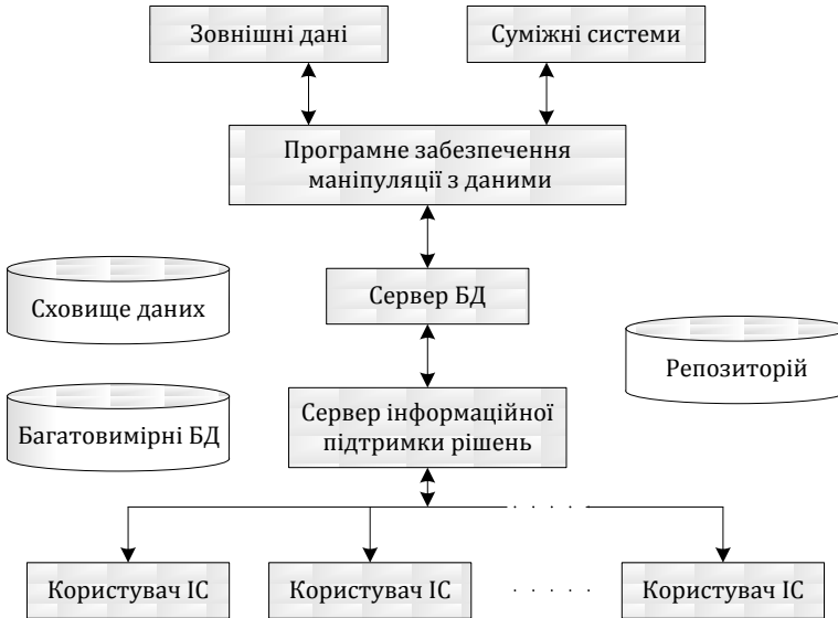
Рис. 3.5. Трирядна архітектура зберігання даних
