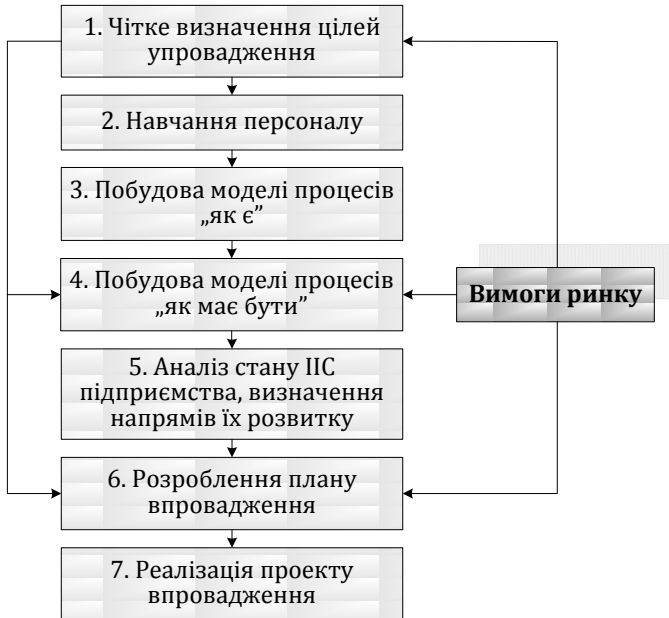
Рис. 2.27. Схема загальної послідовності робіт з впровадження ІС у промислове виробництво
