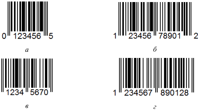
Рис. 1.24. Товарні коди EAN/UPC: а – UPC-E; б – UPC-A; в – EAN-8; г – EAN-13
