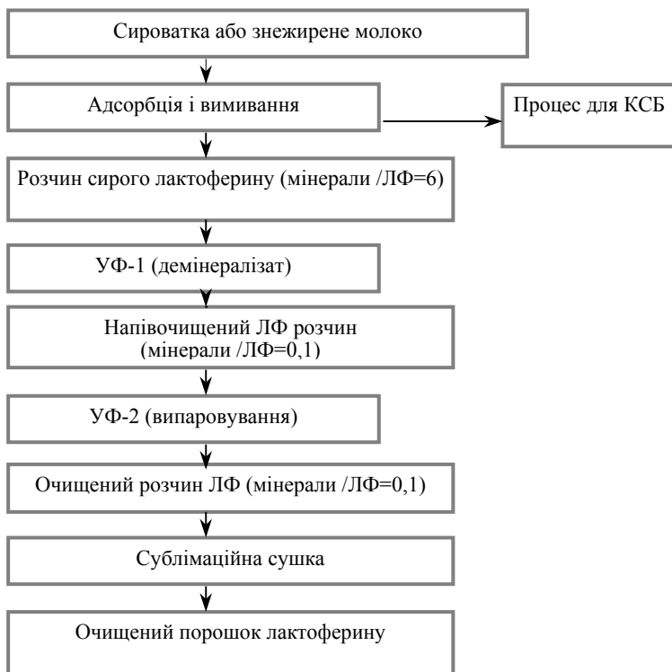
Рис. 2.9. Схема отримання лактоферину
