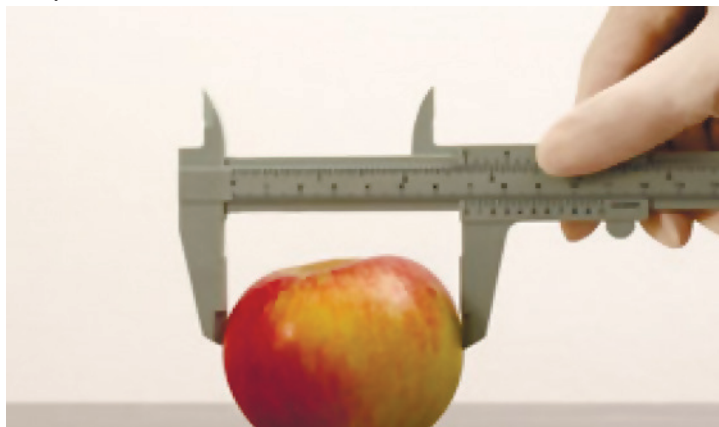
Рис. 128. Одиничний показник якості плодів яблук (вимірювання найбільшого поперечного діаметра плодів яблук штангенциркулем ШЦ-1)
